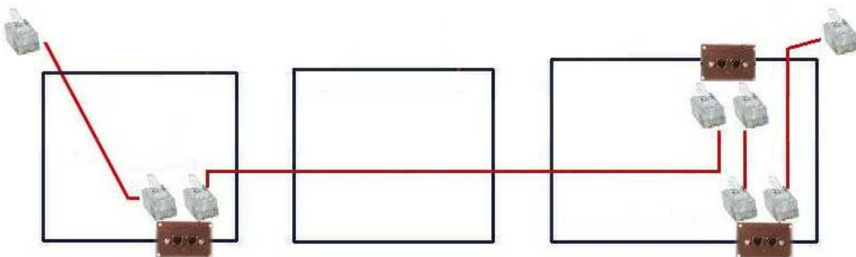
Le module au centre ne dispose pas de platine de commande mais il est obligatoirement traversé par le câble du bus pour assurer la continuité électrique aux modules qui l'encadrent
