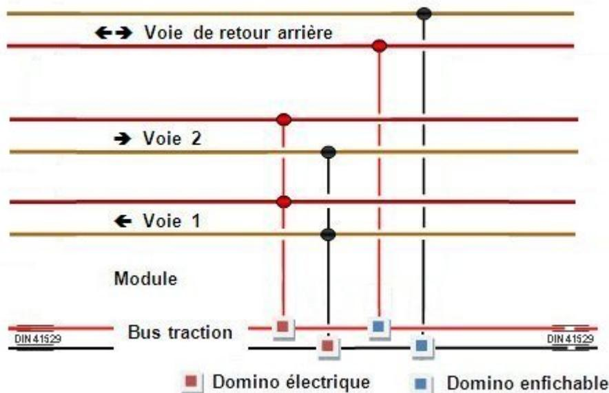
La continuité électrique du bus d'alimentation des voies d'un module à l'autre est assurée par des prises de type radio (DIN 41529 haut-parleur) à deux conducteurs.
