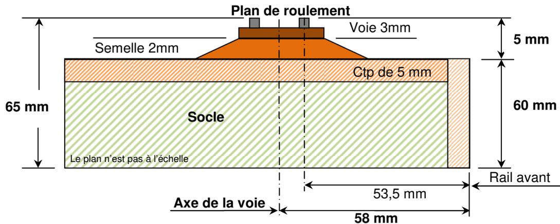
Sur la voie de retour arrière le code 80 peut être utilisé. Dans ce cas une semelle en carton de 0,5mm sera ajoutée pour parvenir à l'épaisseur de 5 mm (voie + traverses).
