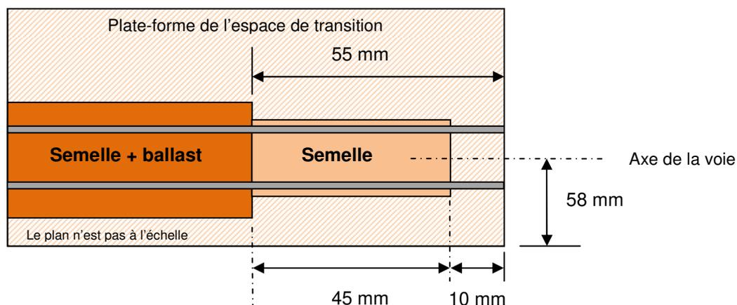
**Important :** Il faut impérativement veillez à apporter un soin tout particulier au parfait respect de la norme aux interfaces. Tout écart, même minime, aura pour conséquence une difficulté d'interconnexion des voies entre les modules au montage.
