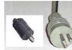
Il est impératif d'avoir un câble de 25cm (avec 2 fils d'une section minimum de 1,5 mm<sup>2</sup>) terminé par une prise radio mâle (DIN 41529) pour se connecter au module voisin. De la même façon, l'embase femelle est obligatoire pour recevoir l'alimentation depuis le module précédent.
