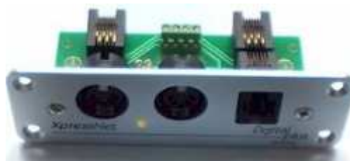
BUS UTP (Universal Throttle Panel) avec prises RJ-12 en face avant
