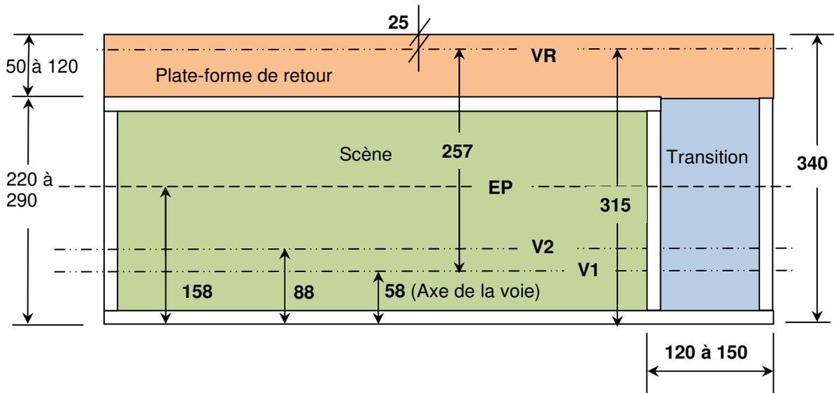
Si on souhaite ajouter une coulisse technique (plusieurs voies sur la plate-forme de retour), l'entre-axe des voies doit être de 30mm à partir de l'axe principal de la voie de retour arrière.
