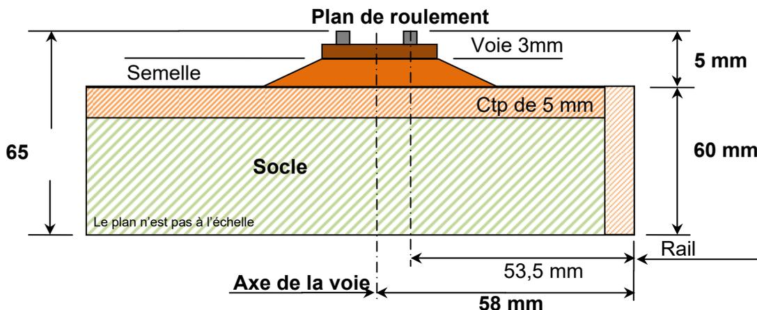
**Important :** Chaque voie comporte à l'extrémité droite du module (dans l'espace de transition) 55 mm de voie qui ne doit être impérativement ni fixée ni ballastée, de façon à pouvoir corriger les petites erreurs d'alignement avec le module suivant.
