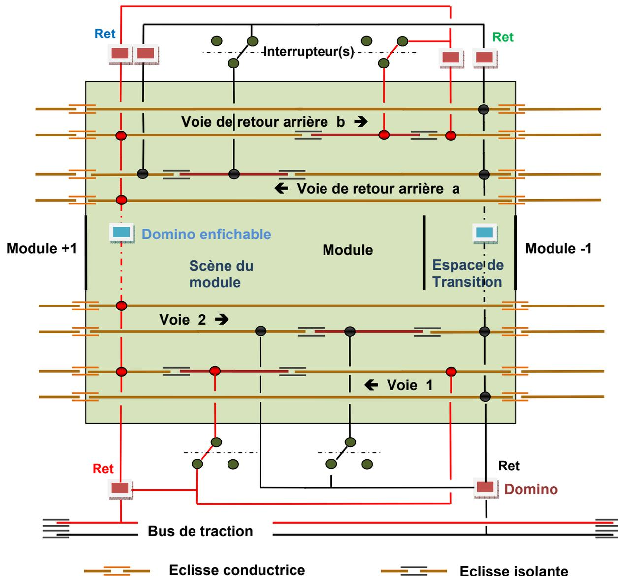
Le coupon de voie de 110 mm et des éclisses isolantes présent au niveau de la transition assure la liaison électrique et mécanique avec le module suivant. Il ne sera ni fixé ni ballasté sur une longueur de 55 mm à son extrémité droite.
