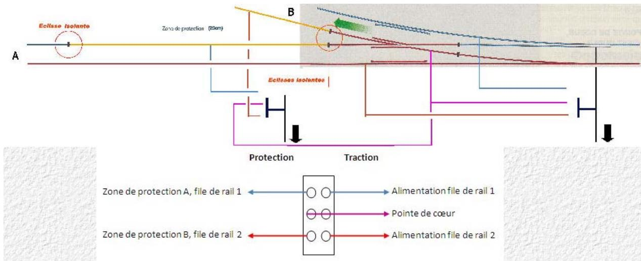
Avec deux aiguillages et deux interrupteurs doubles on peut utiliser le schéma de câblage suivant :
