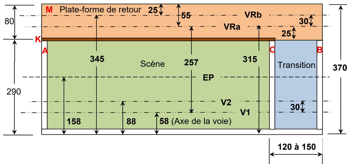
**Nota :** Si on souhaite ajouter une coulisse technique (plusieurs voies avec des aiguillages sur la plate-forme de retour), l'entre-axe des voies doit être de 30mm à partir de l'axe principal de la voie de retour arrière (VRa).
