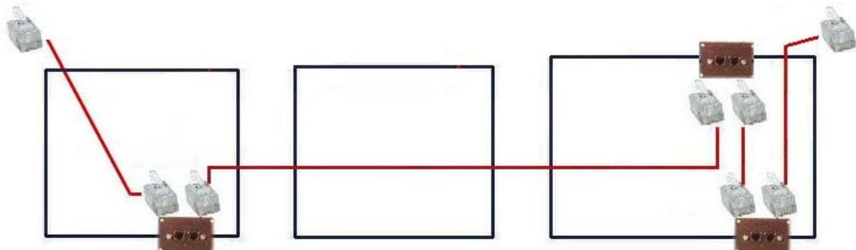
Le module au centre ne dispose pas de platine de commande mais il est obligatoirement traversé par le câble du bus pour assurer la continuité électrique aux modules qui l'encadrent
