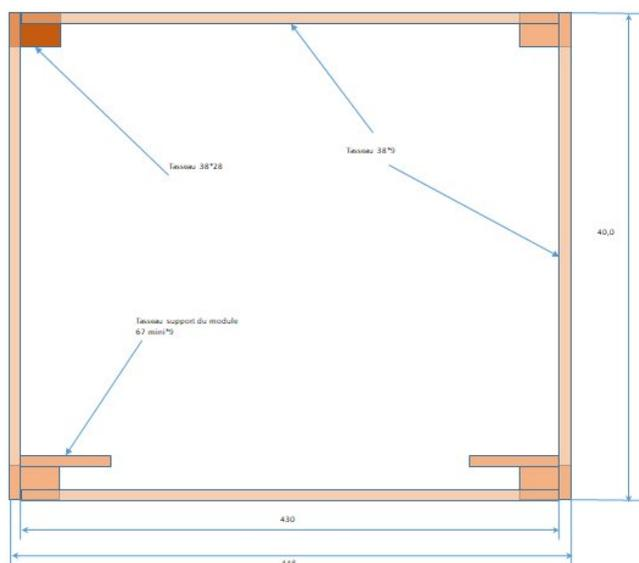
Ce piétement permet d'emboîter le module dans le pied (gain de place pour le transport)
