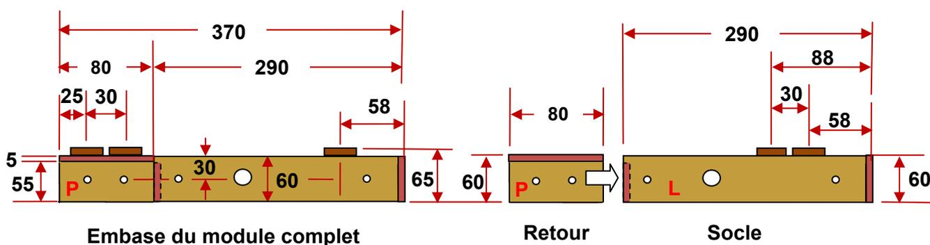
A- Embase avec le socle et les voies intégrées sur le retour arrière
