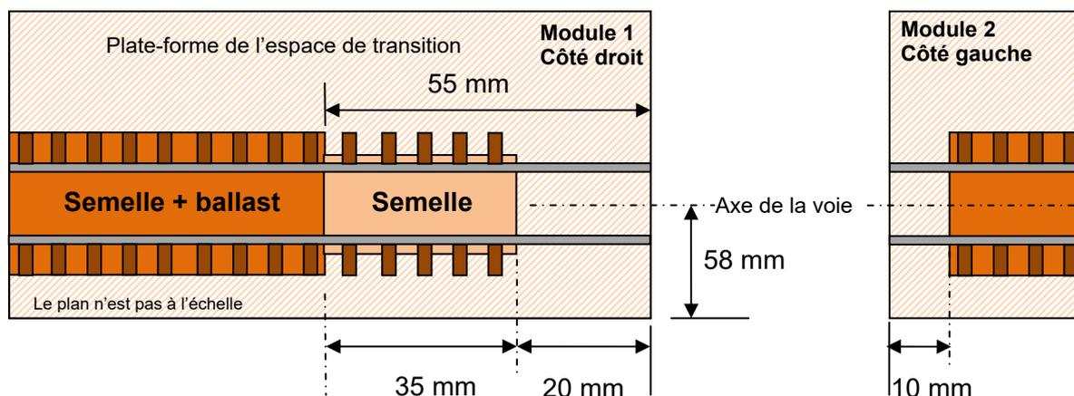
**Important :** Il faut veiller impérativement à apporter un soin tout particulier au parfait respect de la norme aux interfaces. Tout écart, même minime, aura pour conséquence une difficulté d'interconnexion des voies entre les modules au montage.
