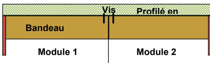
Une solution avec l'ajout d'une équerre sur chaque côté des modules en leur point de jonction permet aussi de rigidifier le point de faiblesse.
