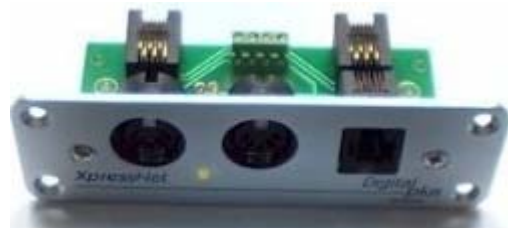
BUS UTP (Universal Throttle Panel) avec prises RJ-12 en face avant
